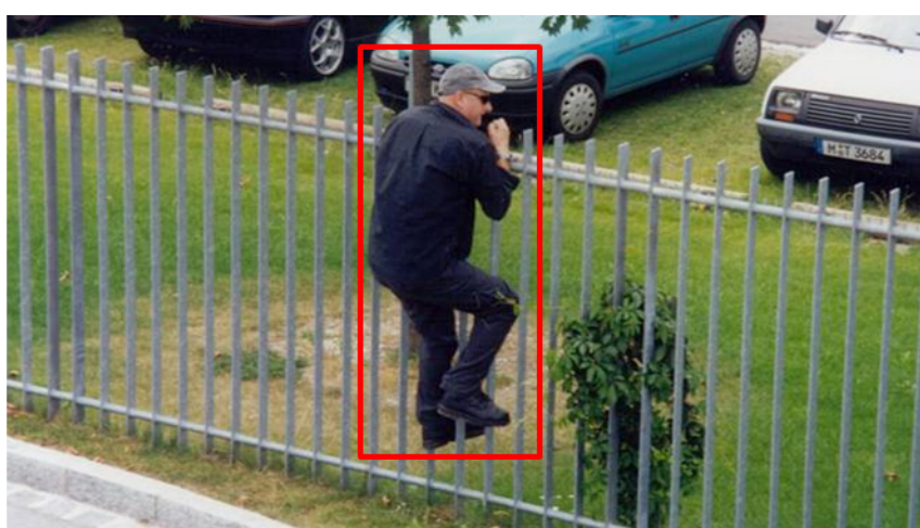
Oben: Exakte Detektion von unerlaubtem Zutritt in gesicherten Bereich mittels vordefinierbarer Zonen und Übermittlung von Eventdaten zwecks Steuerung von I/O-Modulen, Alarmierung, Aufzeichnung usw.
